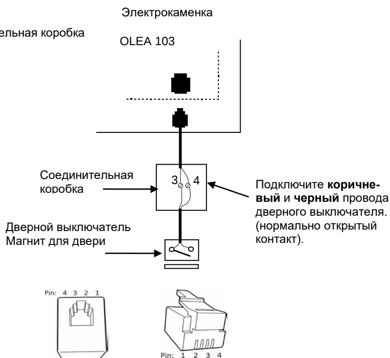
Рис 7. Расположение выводов разъема RJ10 печатной платы.
